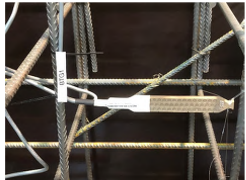
Givare för betong i axiell led, BTG1
