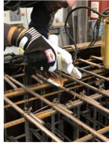
Punktetsning av givare på armering
