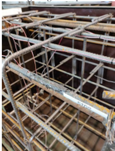
Givarna skyddas med epoximassa
