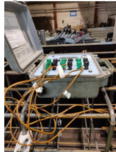
Utrustning för mätning av temperatur 1.a dygnet
