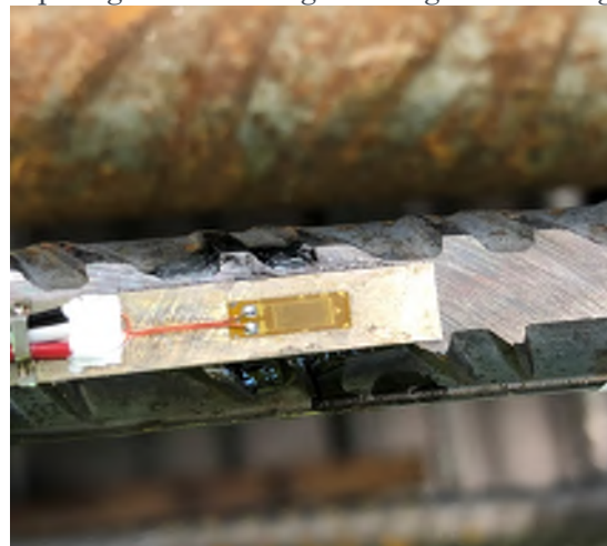
Monterad givare på armering
