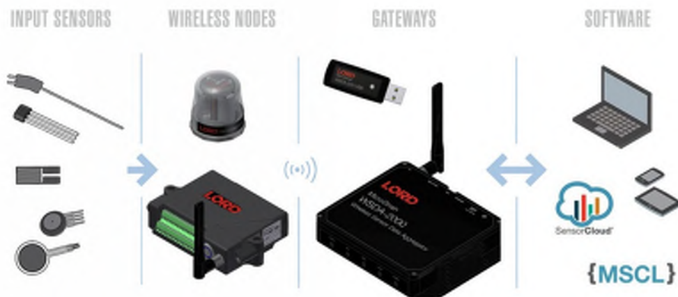
Figur 19 Sladdlöst system som använts för datainsamling ( www.microstrain.com )
