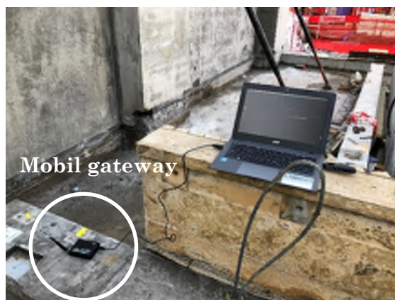
Figur 23 Nedladdning av data från V-Link via mobil gateway (WSDA – Base-LXRS) till dator
